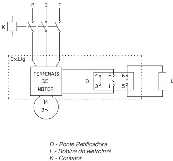
Figura 6.1 - Esquema de ligação para frenagem lenta
