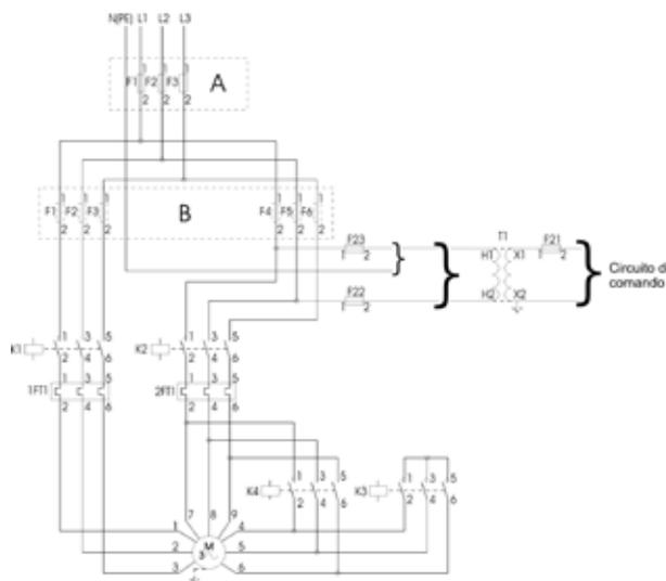
Figura 3.18 - Circuito de força - partida chave série-paralelo
