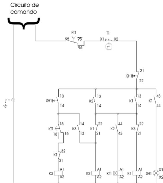
Figura 3.13 - Circuito de comando - partida com chave compensadora
