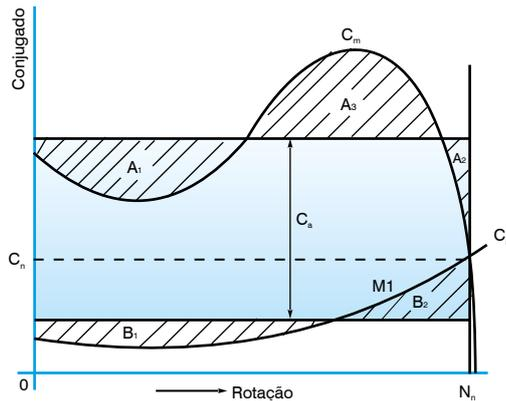
Figura 4.5 - Determinação gráfica do conjugado médio de aceleração
