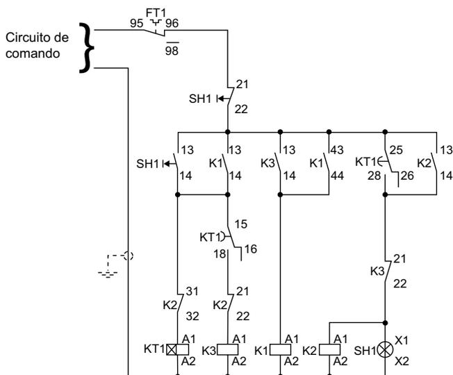
Figura 3.7 - Circuito de comando - partida com chave estrela-triângulo
