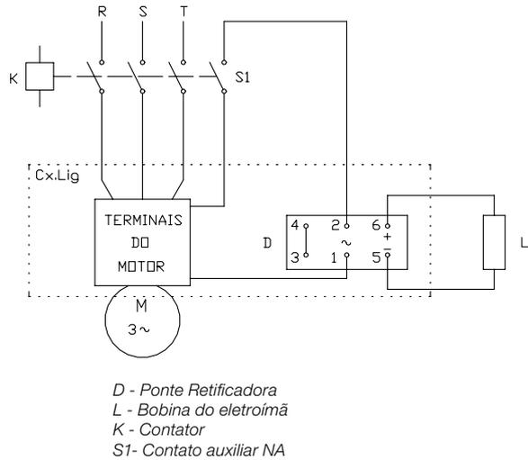
Figura 6.2 - Esquema de ligação para frenagem média
