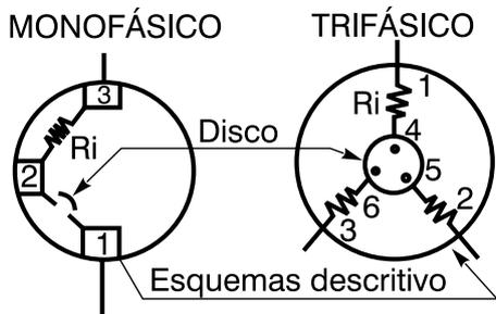
Figura 7.7 - Visualização do aspecto interno do protetor térmico
