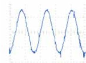
Típica forma de onda de tensão PWM na saída do inversor
