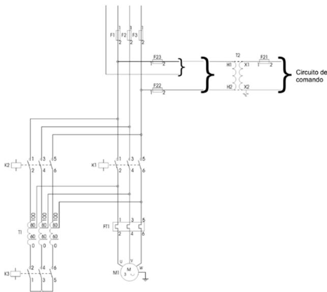
Figura 3.14 - Circuito de força - partida com chave compensadora
