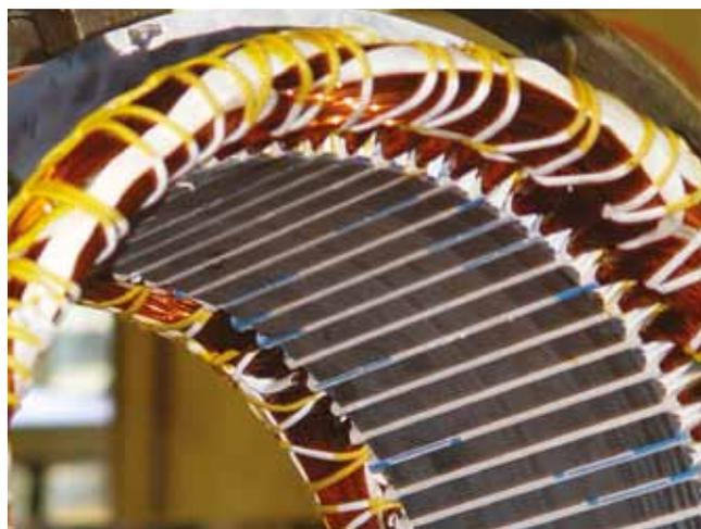
Figura 1.12a – Fios e Filmes aplicados no estator
