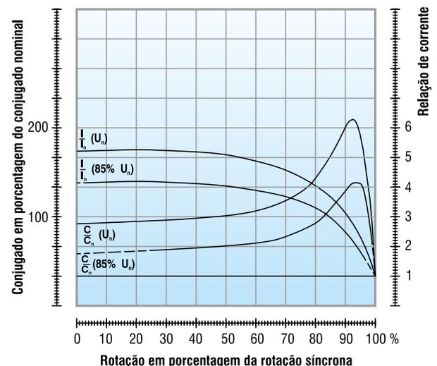
Figura 3.16 - Exemplo das características de desempenho de um motor de 425 cv, VI polos, quando parte com 85% da tensão
